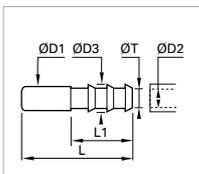
Die Schlauchtüllen 1822 werden auf den Rohranschlussstellen der Verschraubung montiert. Sie treten anstelle des Rohres und werden mit Überwurfmutter und Klemmring, die mit der Verschraubung geliefert werden, angeschlossen.
